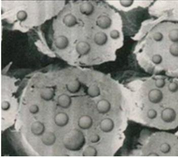
アウトラストファイバーは、大量に熱を吸収・保持・放出する直径2~3ミクロンのマイクロカプセルが繊維の中に組み込まれた温度調節素材です。カプセルの中の成分(特殊相変換物質:パラフィンワックス)が温度変化に応じて、液体⇒個体⇒液体と変化し、吸熱・蓄熱・放熱することで、身体の表面温度を快適な温度帯にコントロールするよう働きかけます。
