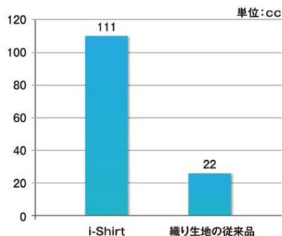
※2 通気量・・・『i-Shirt』、「織り生地の従来品」の生地を用い、日本工業規格(JIS 1096 A 法 フラニール形法)により測定した結果。
